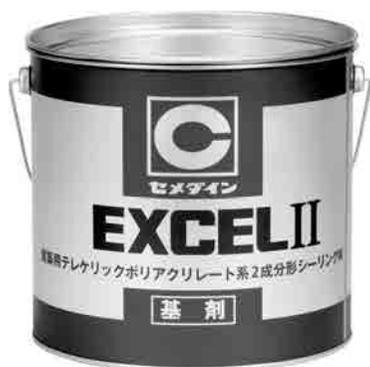
セメダインEXCEL IIは、シリル基末端ポリアクリレート系ポリマーをベースに開発した全く新しいタイプの2成分形建築用シーリング材です。アクリル樹脂の特長である優れた耐候性・耐熱性を有するほか、シーリング材の主要素である耐久性を大幅に向上させることにより、建築用途への幅広い展開が可能になりました。万能タイプの次世代型シーリング材です。
